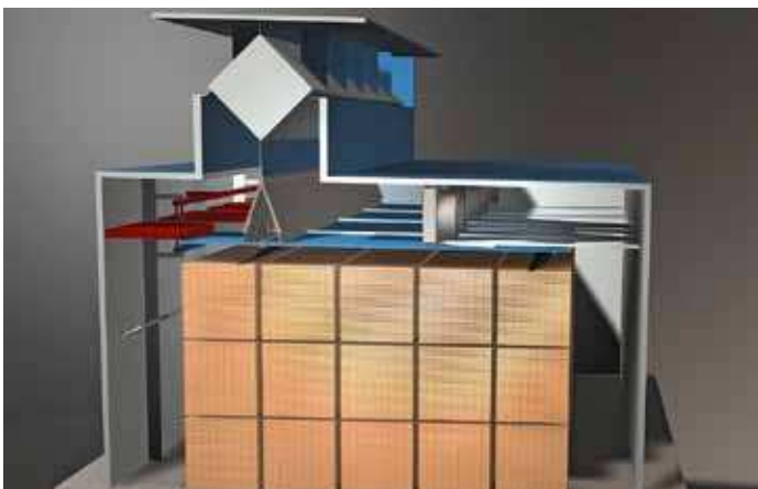
Patentiertes Durchluft-Trocknungsprinzip: Erwärmte Frischluft wird nur ein Mal durch den Holzstapel bewegt
