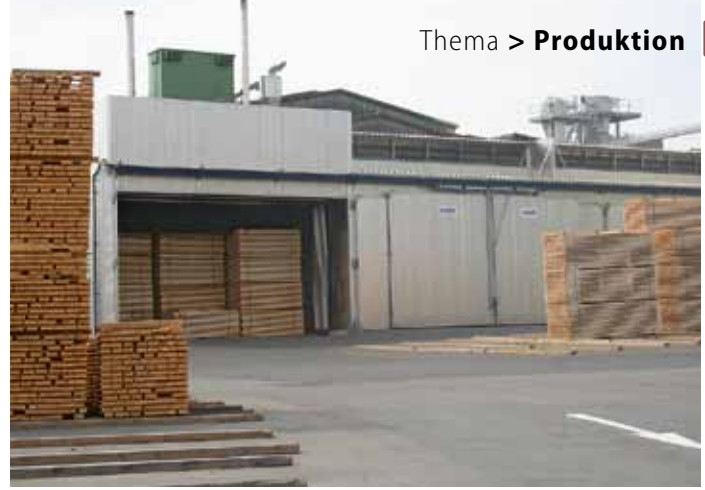
23 mm-Seitenware wird in den neuen Trockenkammern doppellagig, effizient und somit wirtschaftlich getrocknet
